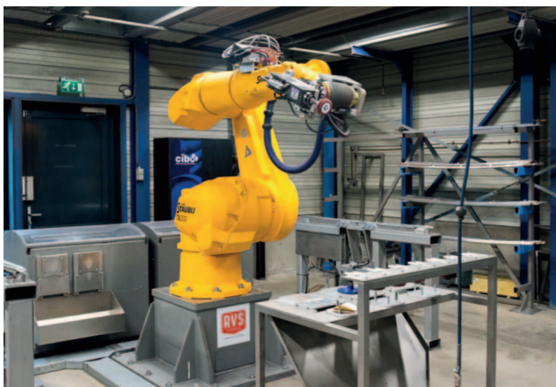
De slijp/polijstrobot voert precies de handelingen uit die een ervaren vakman ook zou uitvoeren. Alleen dan sneller en met een constantere kwaliteit.
