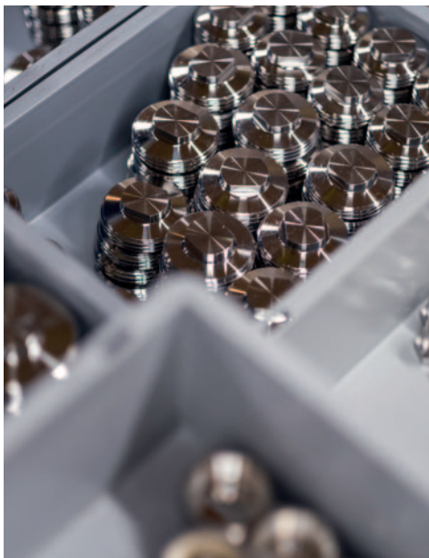
In het Re-use Center worden al de rvs- en titanium-dopjes, bouten en moertjes na terugkomst gecontroleerd op beschadigingen. Foto: Meilink
