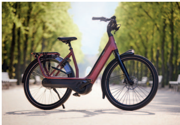
De kettingkast met geïntegreerde motorcover voor de elektrische Gazelle Avignon HMB is makkelijker uit elkaar te halen en te recyclen. Foto: Gazelle
