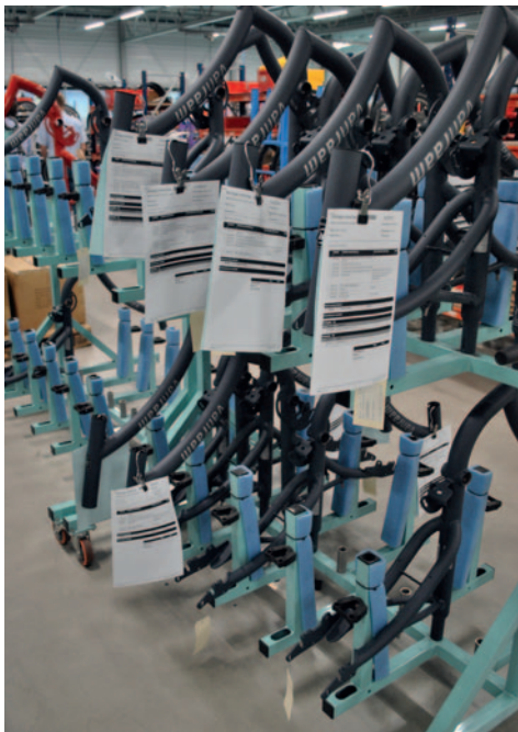
Elke fiets van Van Raam is anders; dus wordt bij elk frame nauwkeurig bijgehouden welke opties er in de werkplaats moeten worden gemonteerd.
