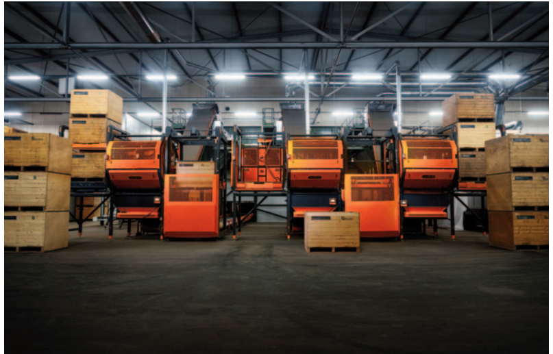
VHM Machinery automatiseert de logistiek in de agrofoodketen. Zo ook met deze sorteerlijn, die bestaat uit shuttles, liften en doorvoerbanen. Foto: VHM
